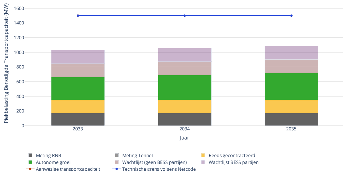
Figuur 2.6.1 Overzicht van de aanwezige, benodigde en gevraagde transportcapaciteit, alsmede de technische grens volgens de Systeemcode in deelnet Eindhoven, uitgesplitst tijdens de hoogste piekbelasting.
